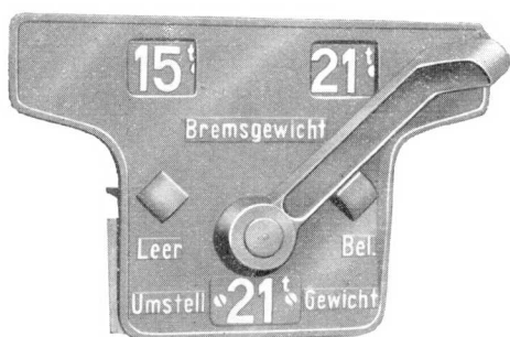
Abb. 30 Bremsgewicht-Schildlager mit beweglichen Zahlenschildern
