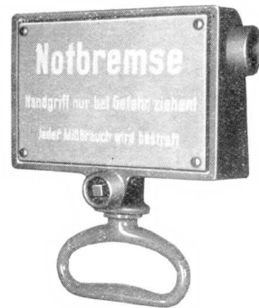
Abb. 34 Notbremszugkasten ZM 4
