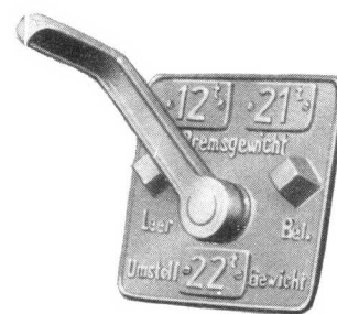
Abb. 29 Bremsgewicht-Schildlager mit festen Zahlenschildern
